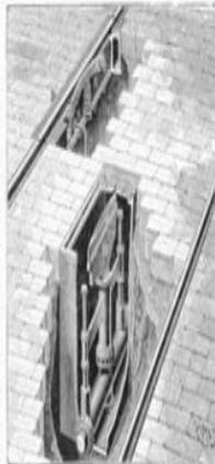
Fig. 2. — Appareil pour la prise d'air sur la voie.
